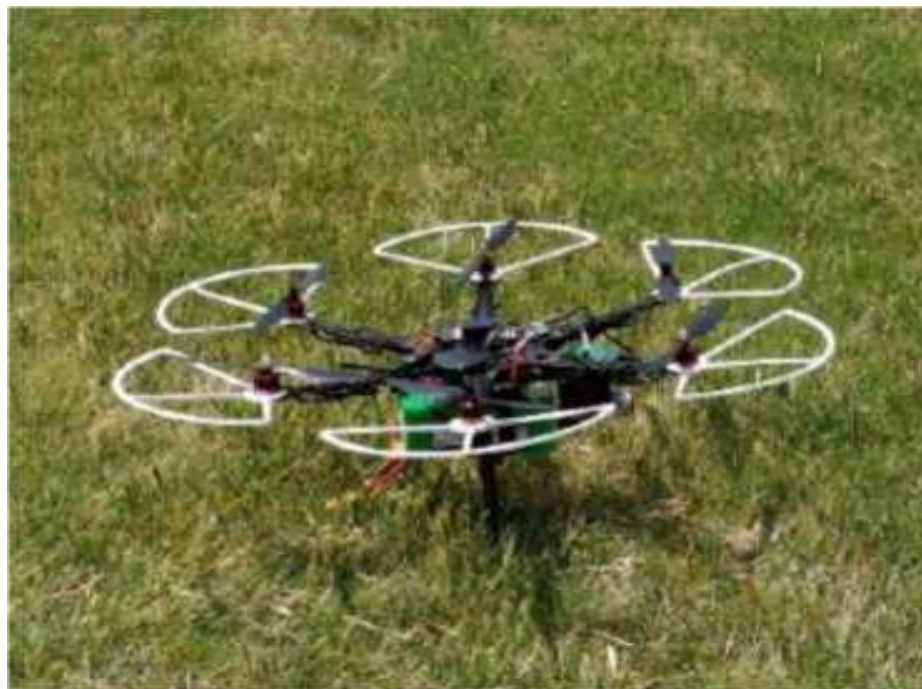
Rycina 3. Dron z zamontowanym systemem do pomiaru cząstek stałych w powietrzu.
