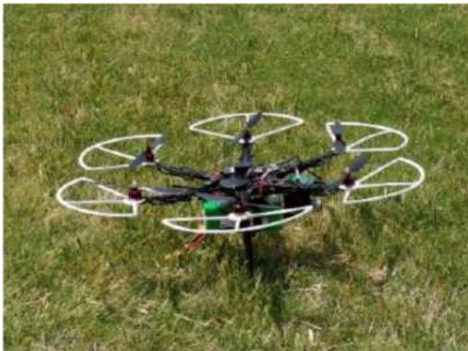
Obrázok 3: Dron so systémom na meranie vzdušných častíc na mieste.
