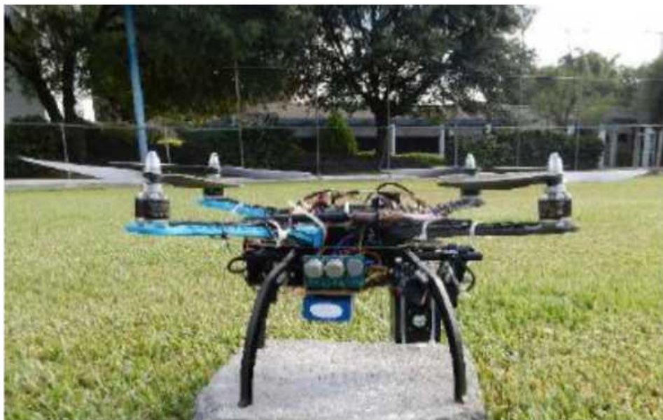
Obrázok 2: Dron s namontovanými senzormi na analýzu znečistenia ovzdušia.
