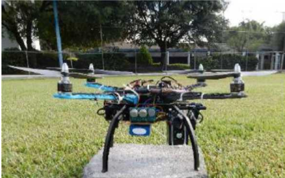
Rycina 2. Dron z zamontowanymi czujnikami do analizy zanieczyszczenia powietrza.
