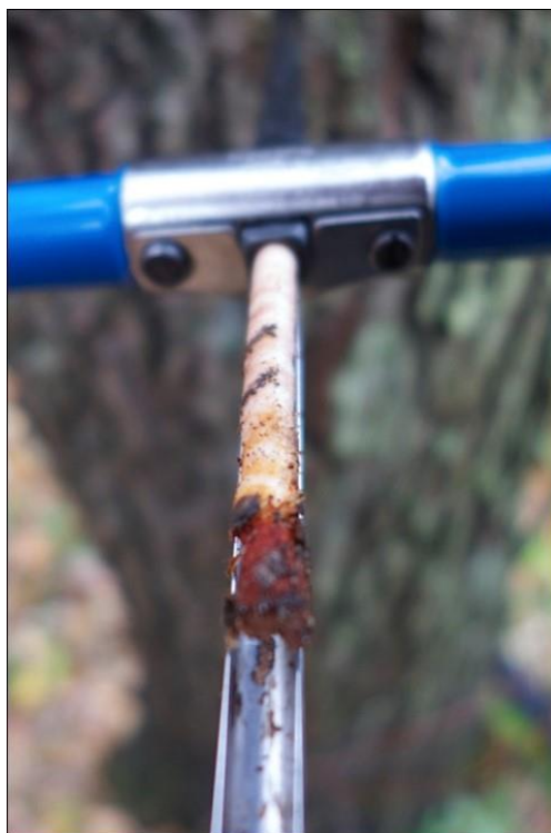
Rycina 12. Świder Presslera z rdzeniem pobranym z drzewa (u dołu)
