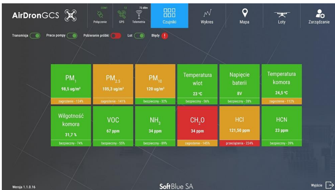
Rycina 6. Matryca odczytu jakości powietrza z wartościami w poszczególnych kategoriach zanieczyszczeń informująca o przekroczeniach norm (AIRDron firmy SOFTBlue)
