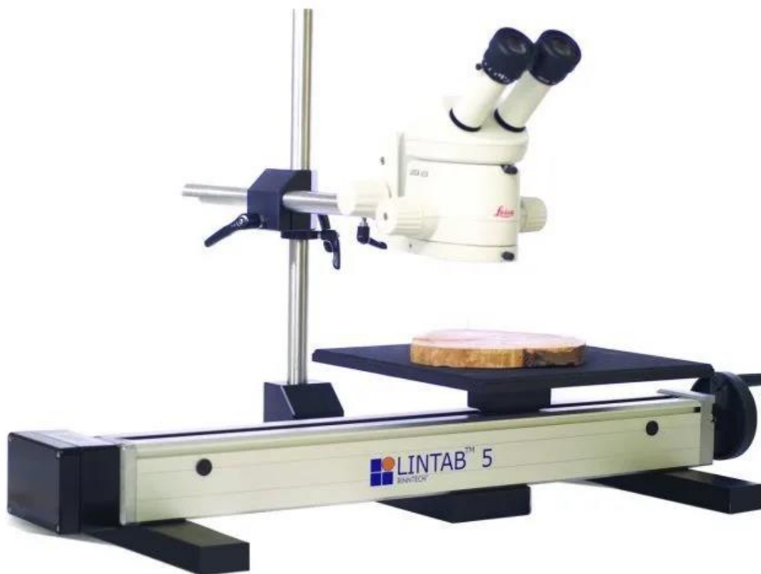
Rycina 16. Przyrostomierz do pomiaru przyrostów rocznych drewna
