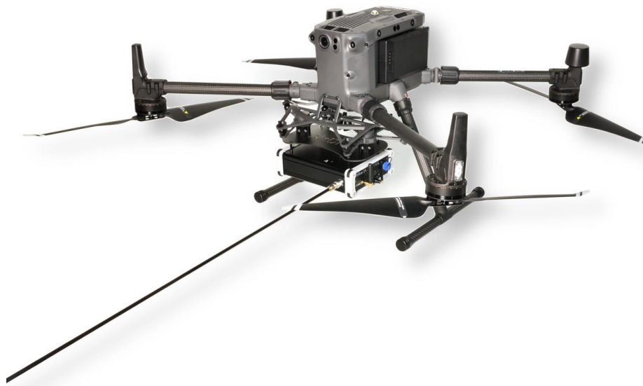
Rycina 1. Dron wykorzystywany do transportu sprzętu pomiarowego pozwalającego ocenić jakość powietrza.
