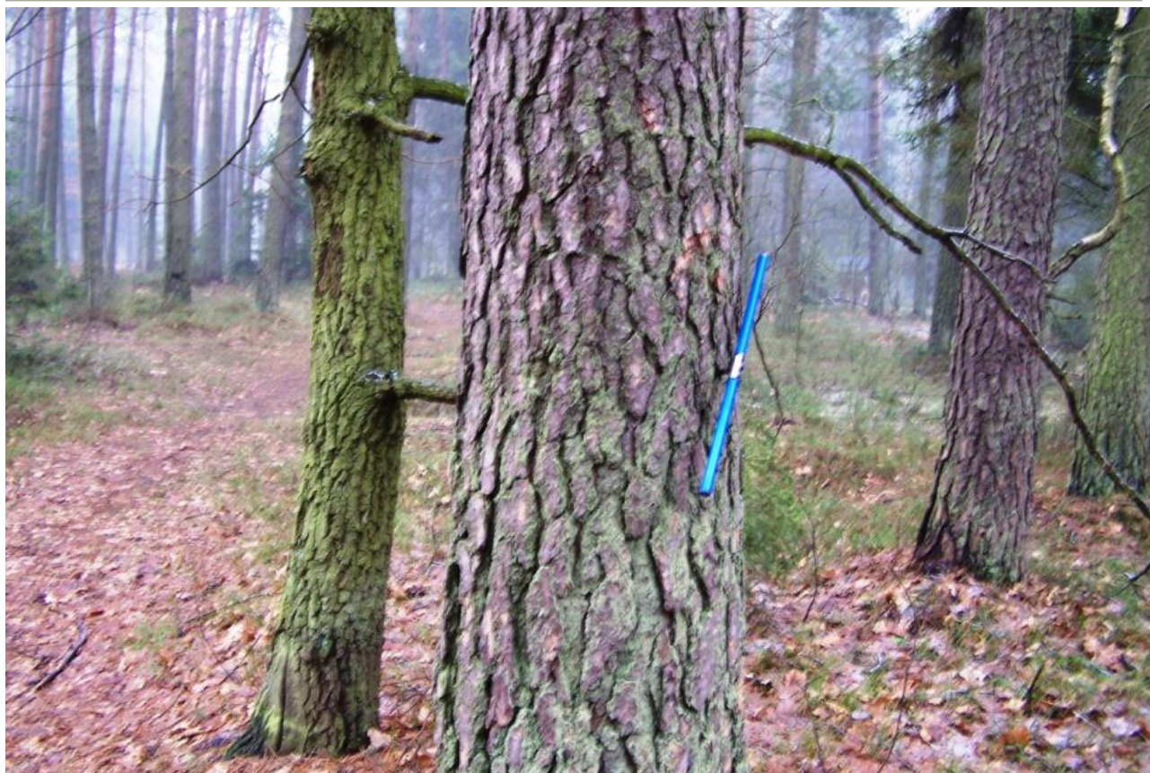
Rycina 13. Świder Presslera tkwiący w sośnie na wysokości pierśnicy (1,3 m)
