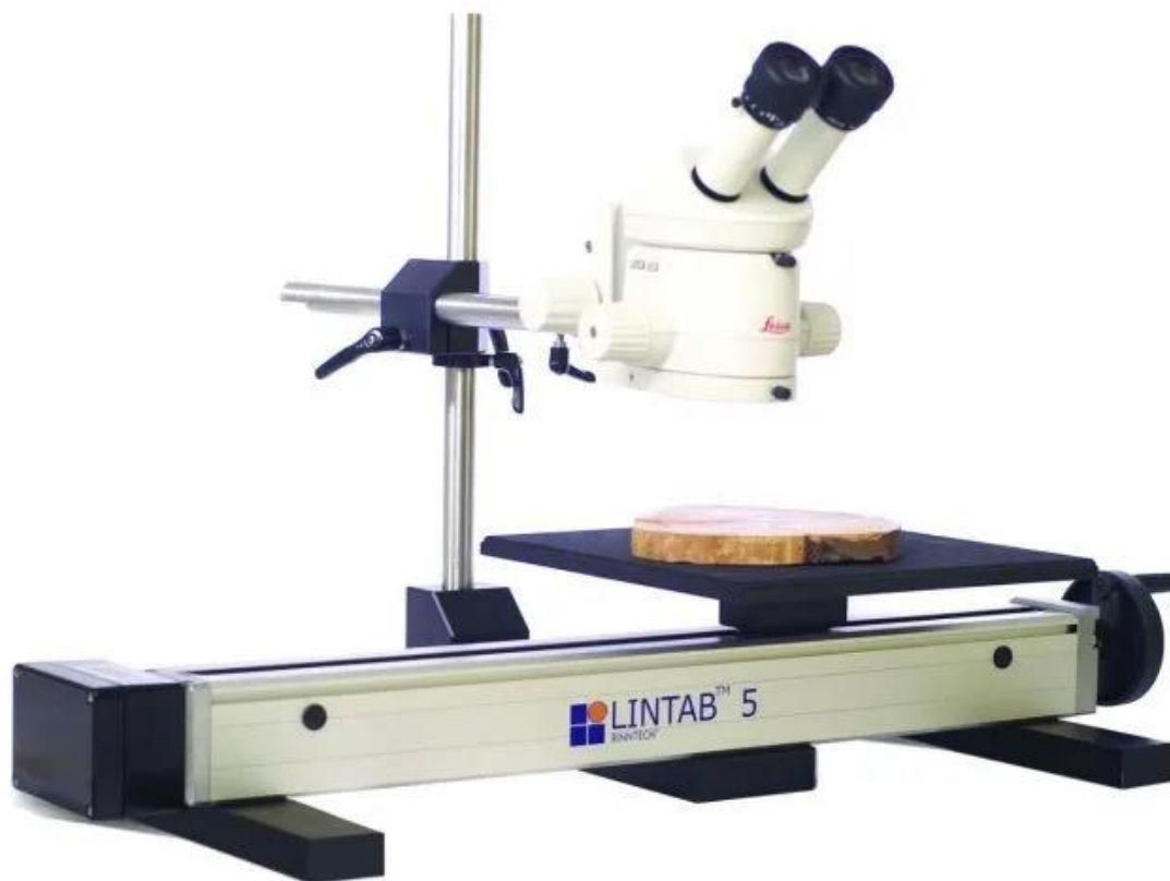
Obrázok 16. Prírastkomer na meranie ročných prírastkov dreva
