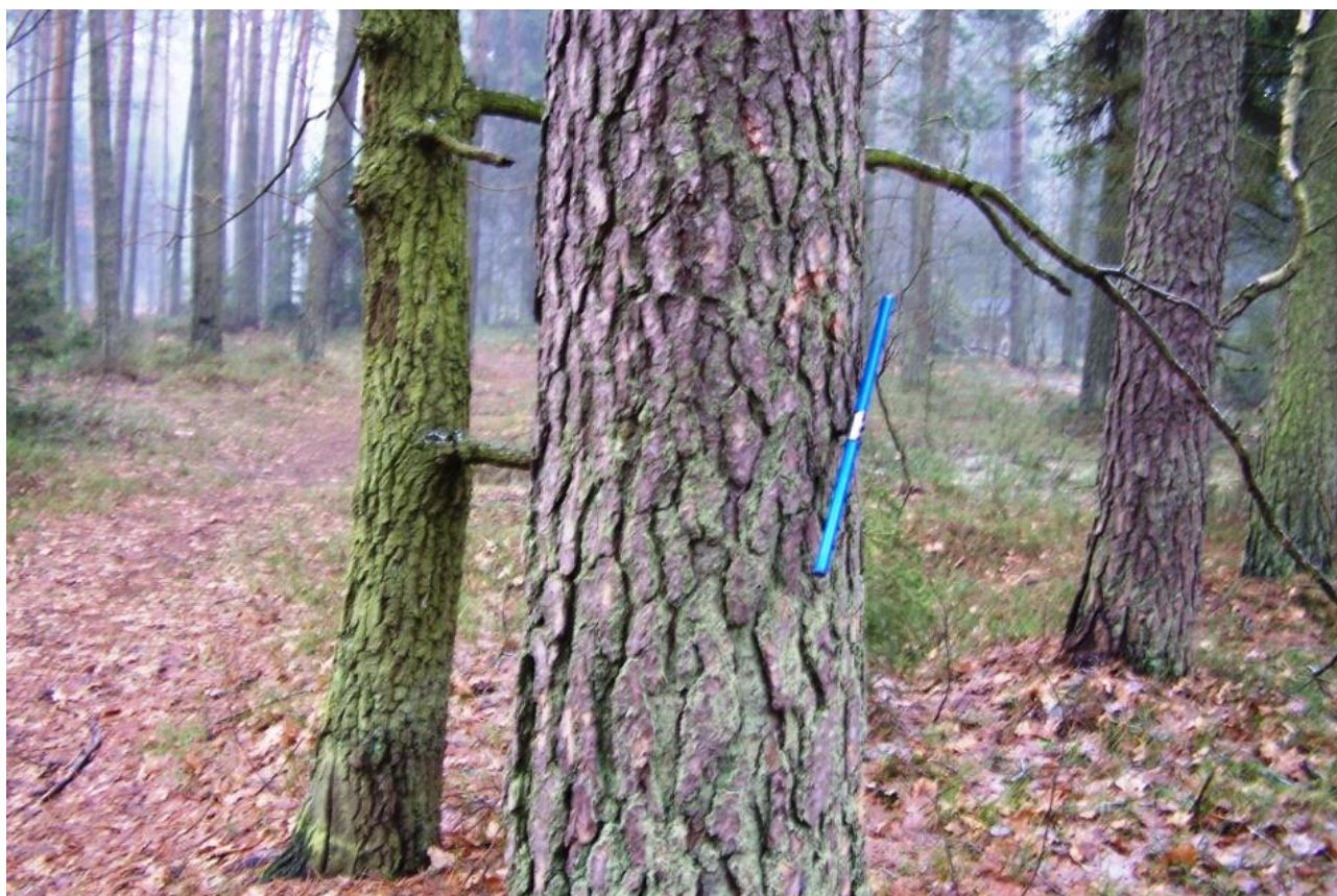
Obrázok 13: Presslerov vrták zaseknutý v borovici v prsnej výške (1,3 m)
