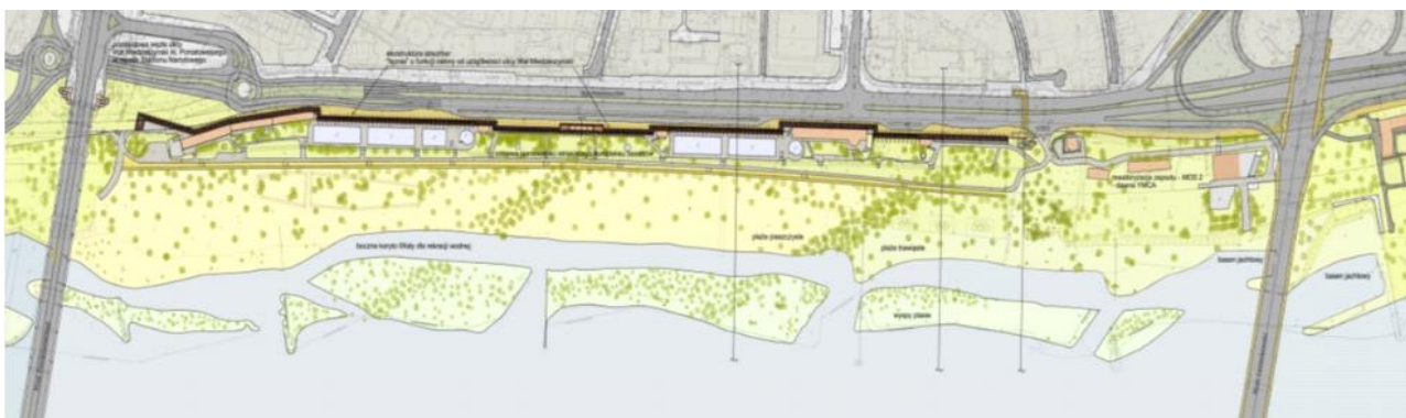
Rys. 6. Schemat uformowania bocznego koryta Wisły i wysp w rejonie Saskiej Kępy.
