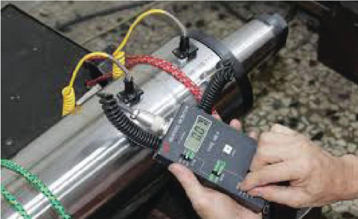
Rys. 6. Kontrola czujników wbudowanych we wrzeciono.
