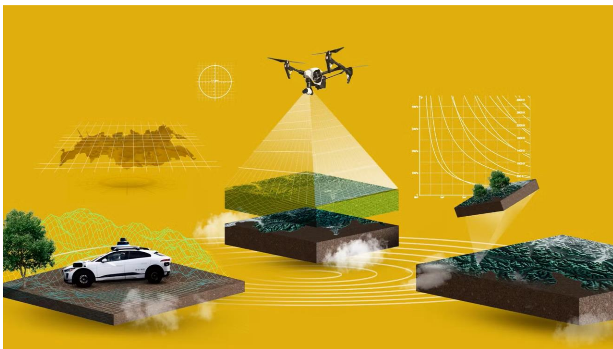
Rycina 15. Idea działania skanera laserowego, na rycinie widoczny dron z kamerą LiDAR, wiązka promieni laserowych i skanowana powierzchnia gruntu.
