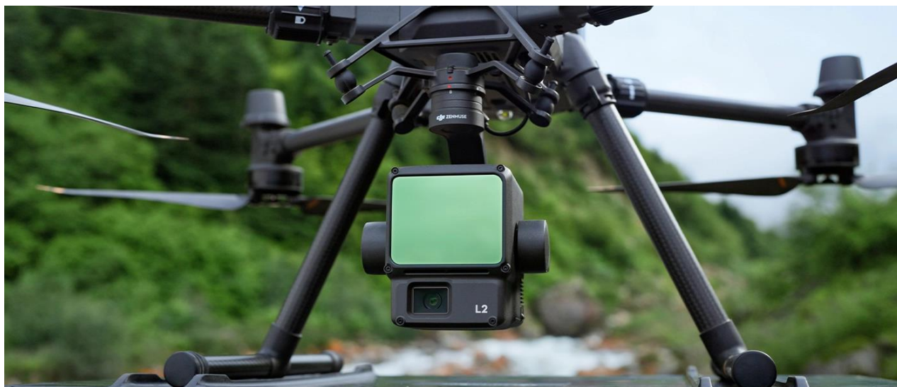
Rycina 16. Dron wyposażony w zestaw do skanowania powierzchni gruntu LiDAR.
