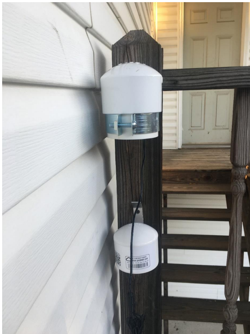
Obr. 4. Príklad nainštalovaného nízkonákladového senzora znečistenia ovzdušia (zdroj: https://grist.org/health/low-cost-sensors-are-helping-communities-find-gaps-in-air-quality-data/ ).
