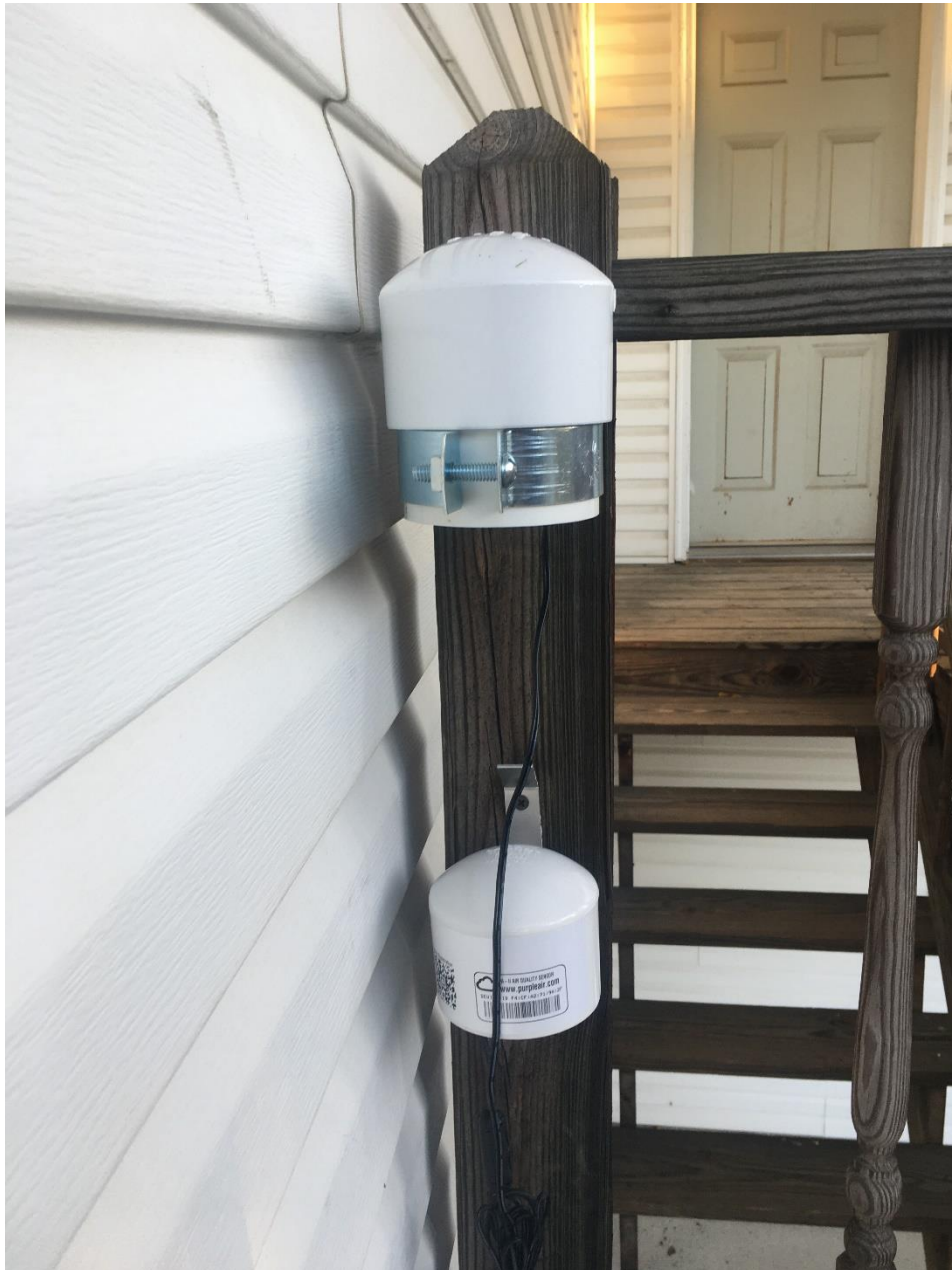
Fig. 4. Przykład zamontowanego niskokosztowego sensora zanieczyszczenia powietrza (źródło: https://grist.org/health/low-cost-sensors-are-helping-communities-find-gaps-in-air-quality-data/ ).
