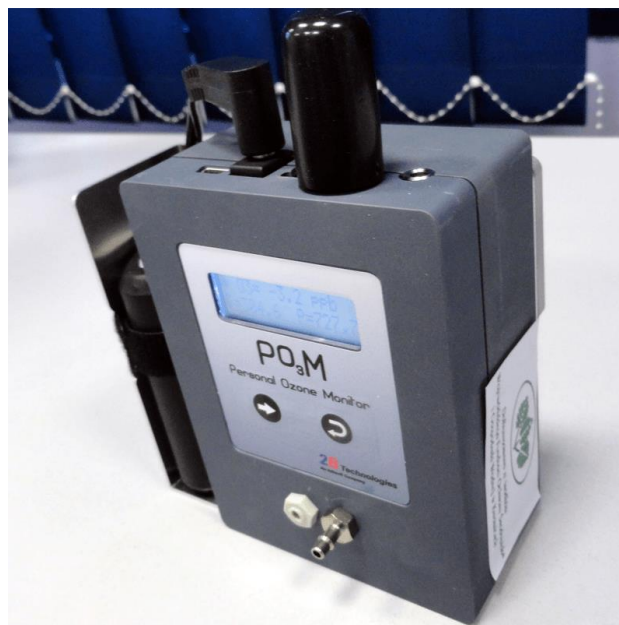
Ryc. 2. Analizator ozonu POM 2B Technology – jedno z urządzeń działających na pokładzie mobilnych laboratoriów (źródło: https://us.edu.pl/nauka-i-badania/centra-badawcze/ulka/ulka-aparatura/ ).
