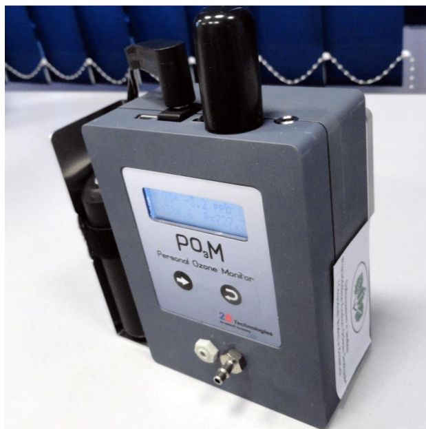
Obr. 2. Ozónový analyzátor POM 2B Technology – jedno zo zariadení používaných na palube mobilných laboratórií (zdroj: https://us.edu.pl/nauka-i-badania/centra-badawcze/ulka/ulka-aparatura/ ).
