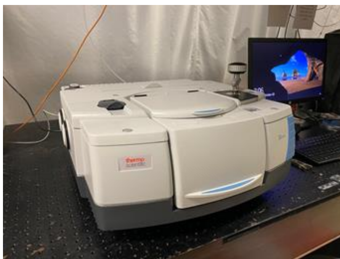
Ryc. 3. Thermo Nicolet – przykład laboratoryjnego spektrometru FTIR (źródło: https://mrl.illinois.edu/facilities/equipment/thermo-nicolet-nexus-is50-ftir )
