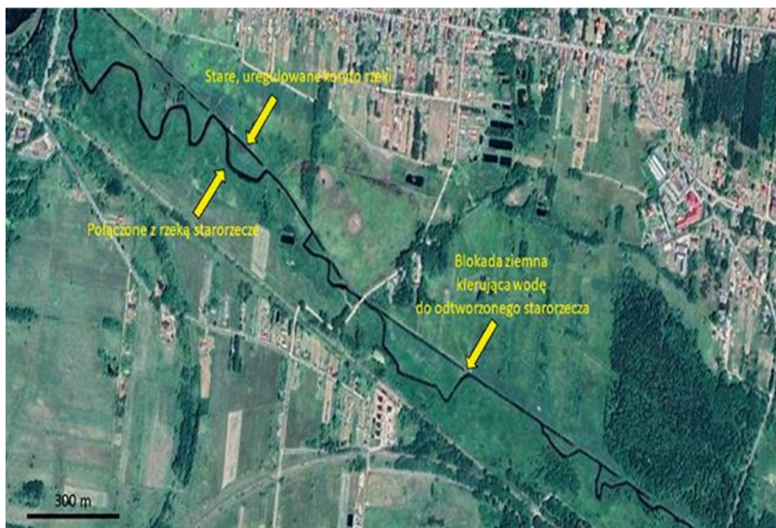
Obrázok 4. Obnova pôvodného meandrujúceho toku rieky Narewka v Białywieży prostredníctvom zablokovania prietoku v regulovanom koryte a nasmerovania vody do obnovených mŕtvych ramien ( https://inzynierbudownictwa.pl/renaturyzacja-rzek/ ).
