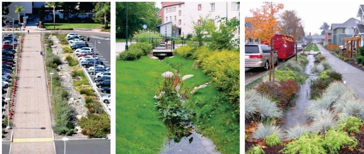
Obrázok 8. Infiltračný priekop (vľavo) a bioretenciačné priekopy („Drogownictwo” 4/2017).
