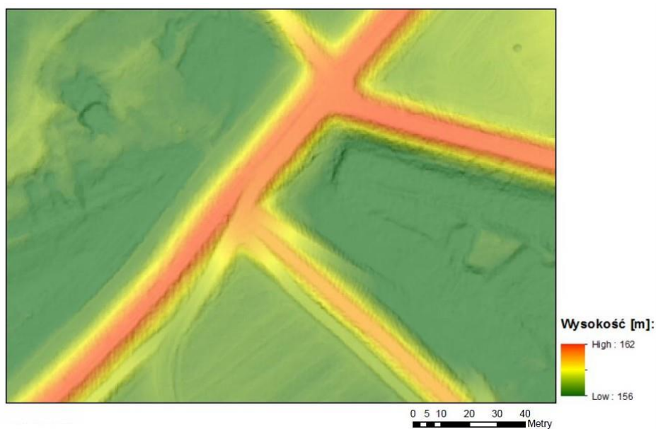
Rycina 14. Przykład obrazu uzyskanego przez nałożenie modelu cieniowanego i barw hipsometrycznych-uzyskano szczegółową topografię wału przeciwpowodziowego (Kurczyński Z., Bakuła K., 2016).
