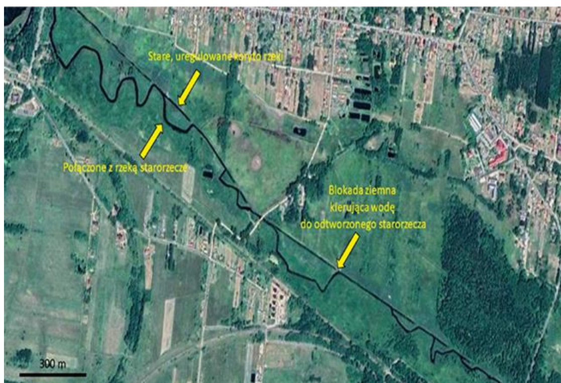
Rycina 4. Przywrócenie dawnego meandrującego biegu Narewki w Białowieży przez zablokowanie przepływu w uregulowanym korycie i skierowanie wody do odtworzonych starorzeczy ( https://inzynierbudownictwa.pl/renaturyzacja-rzek/ ).
