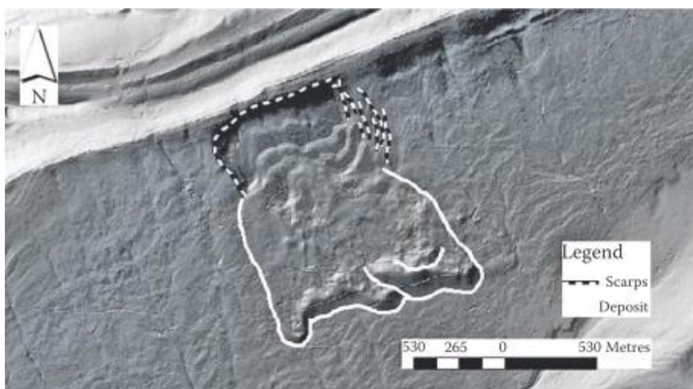
Obrázok 8. Model terénu zosuvu založený na údajoch LIDAR.
