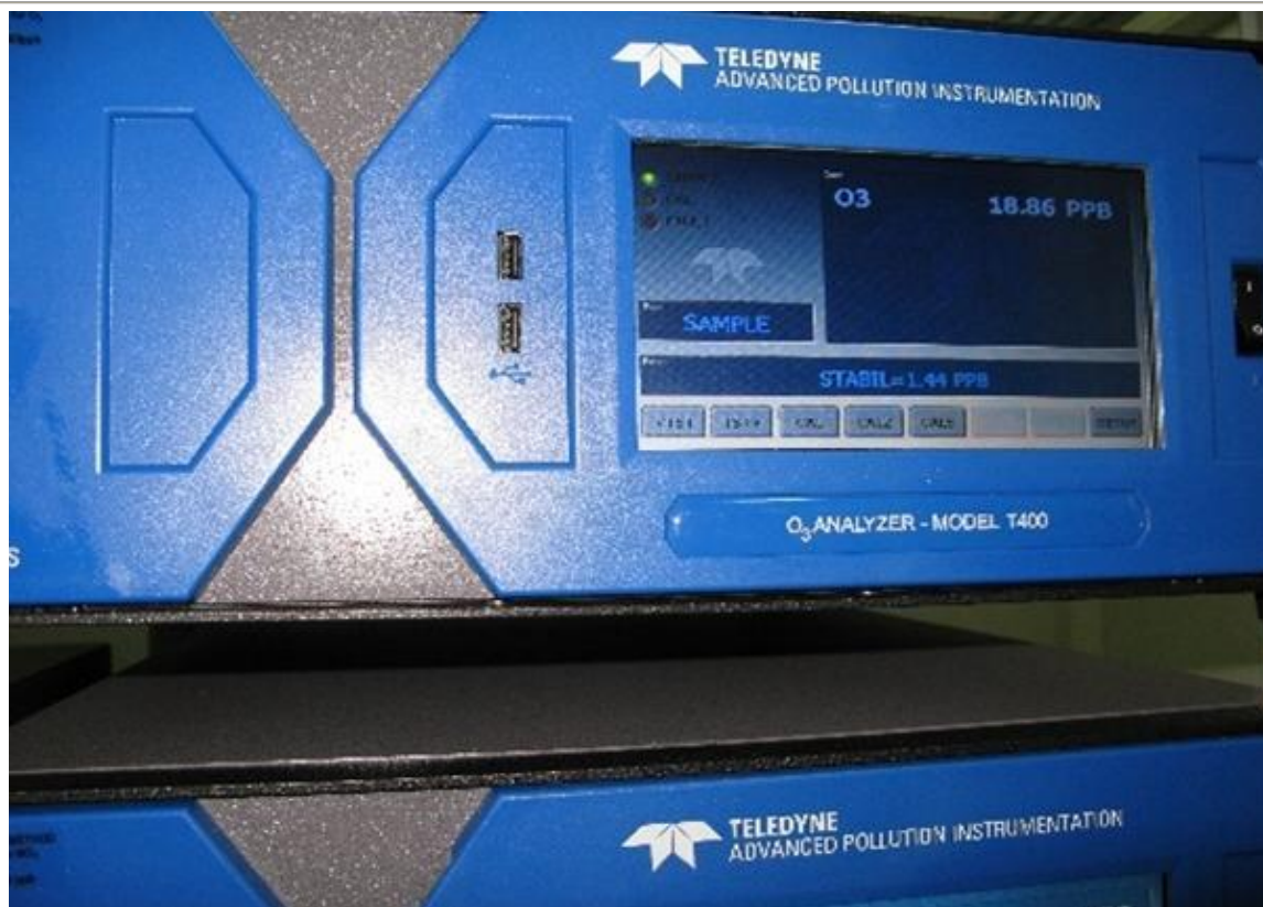
Ryc. 5 Analizator O 3 działający w oparciu o metodę fotometrii UV (źródło: https://powietrze.gios.gov.pl/ )
