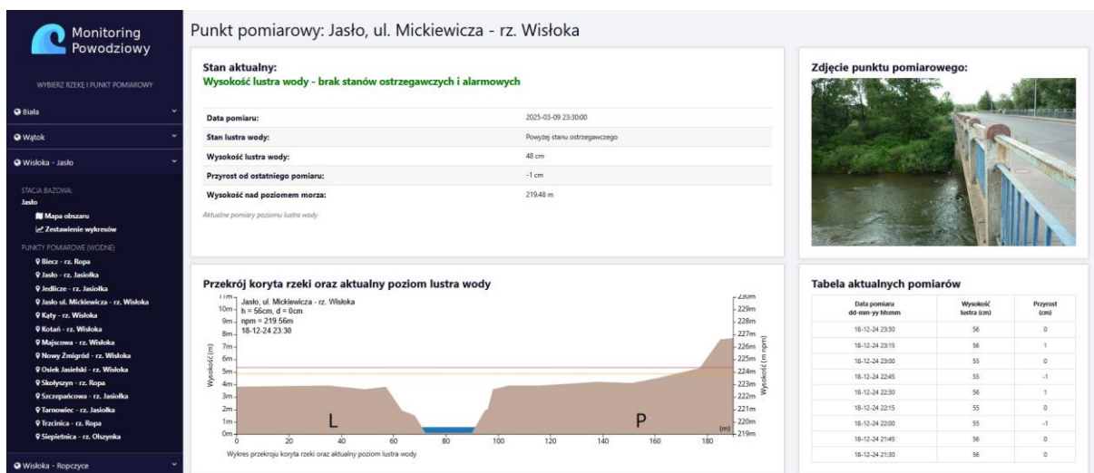
Rycina 45. Przykład prezentacji danych w systemie monitoringu powodziowego ( https://monitoring.prospect.pl ). Po kliknięciu na wybraną stację pomiarową wyświetlają się: stan wody, przekrój koryta rzeki, zdjęcie punktu pomiarowego, dobowy wykres historii pomiarów w czasie oraz prognozę. Dostępny jest także przegląd pomiarów historycznych.
