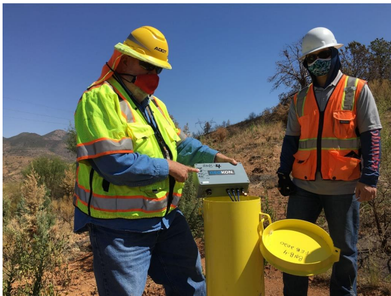
Rycina 7. Sonda umieszczona w kolumnie inklinometrycznej
