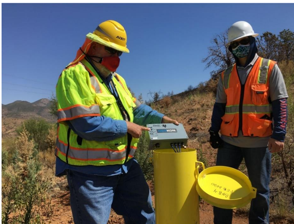
Obrázok 7. Sonda umiestnená v inklinometrickej kolóne.
