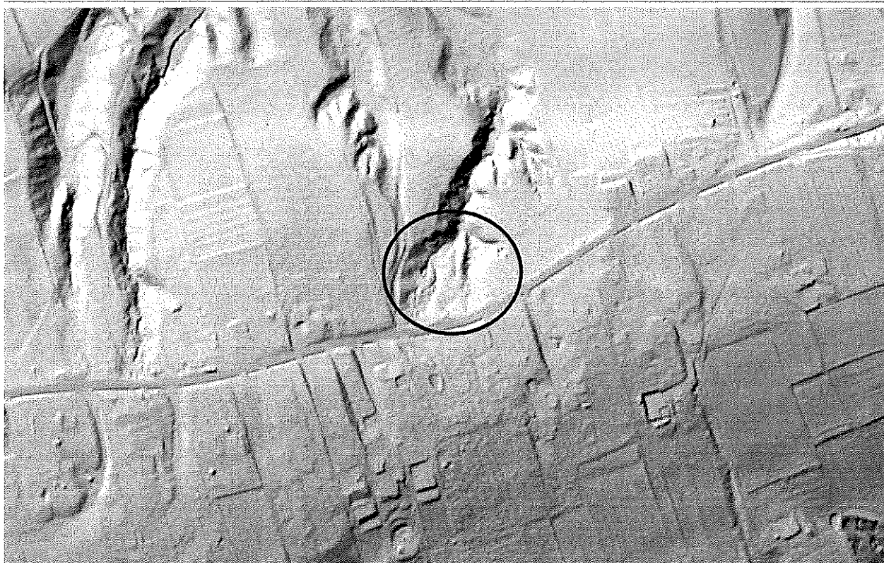
Rycina 2. Model terenu obrazujący morfologię i położenie osuwiska.
