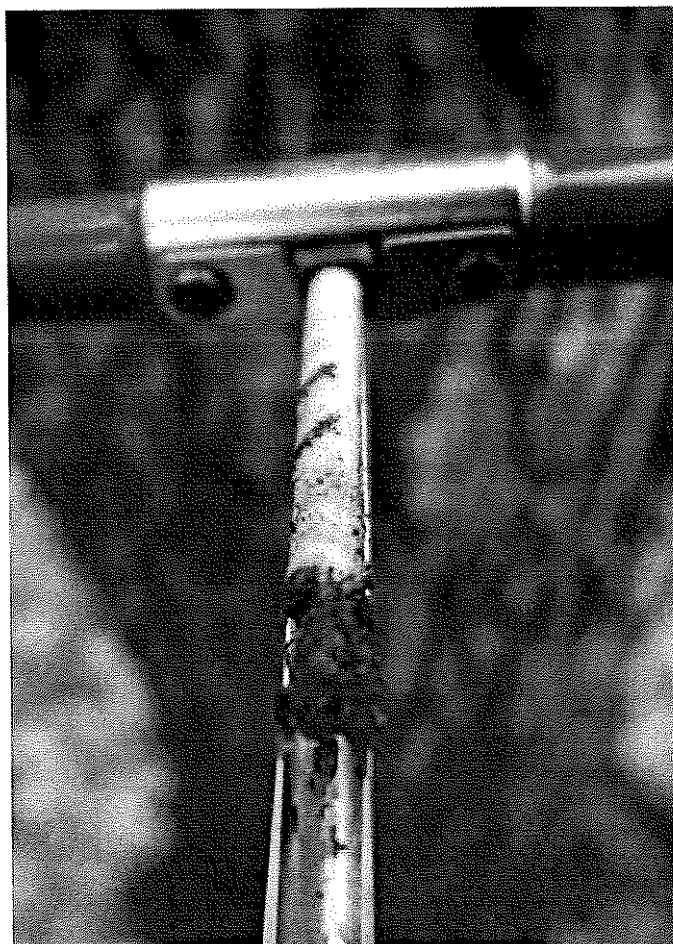
Rycina 2. Świder Presslera wraz z rdzeniem pobranym z drzewa.
