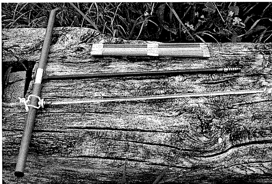
Rycina 2. Świder Presslera złożony z rączki, z części rdzeniującej oraz łyżka do wyciągania rdzeni.
