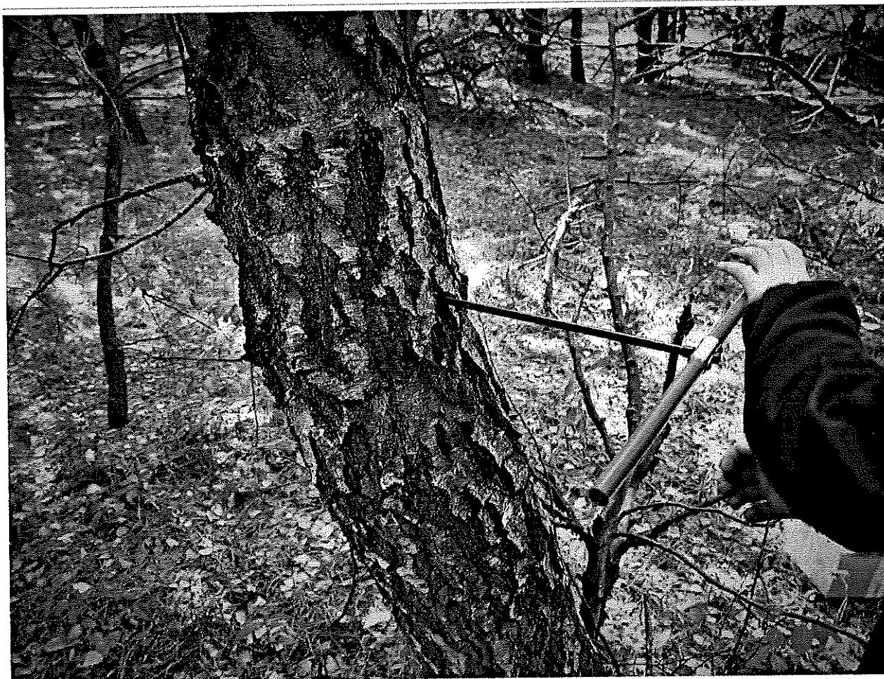
Obrázok 2. Presslerov nebožiec na odber vzoriek zo stromov.
