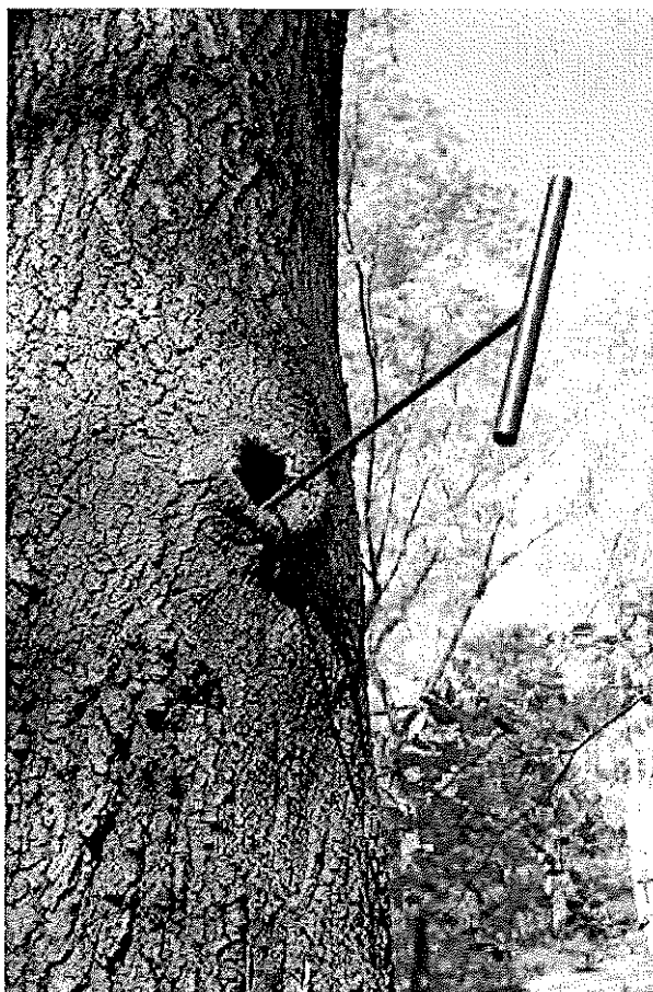
Obrázok 2. Presslerov nebožiec na odber vzoriek zo stromov.
